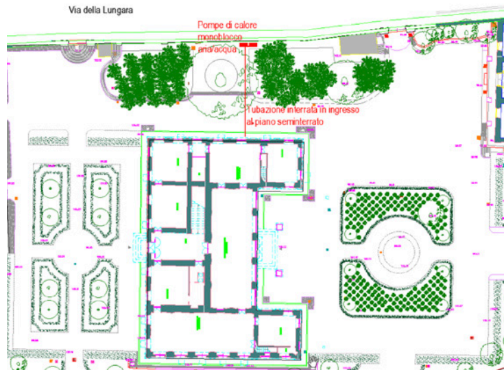
Vista in pianta della posizione della PdC e delle tubazioni interrate di collegamenti al piano seminterrato della Villa.
